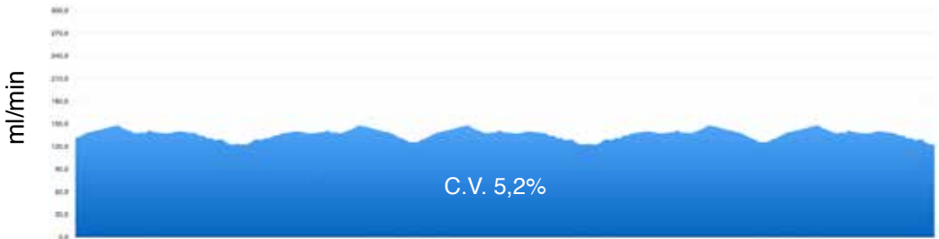
EUROGET - Versione standard - Diagramma di distribuzione con somma dei passaggi a 9 metri
