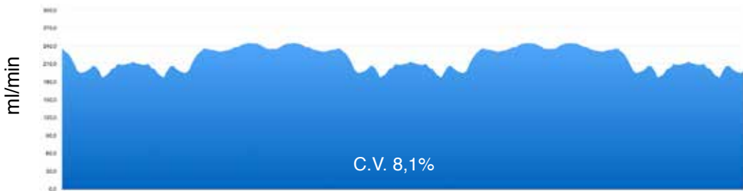
DUPIGET PRECISION - Versione standard - Diagramma di distribuzione con somma dei passaggi a 9 metri
